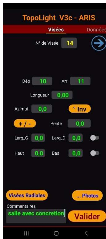
ARIS TopoLight est un carnet de relevés topographique classique, il permet avec des outils non connectés à bas couts, tel une Boussole, un Clisimètre et un Laser mètre de mémoriser les données afin de les récupérer au format VISUAL TOPO, d'Eric DAVID» en format « .TRO ».
